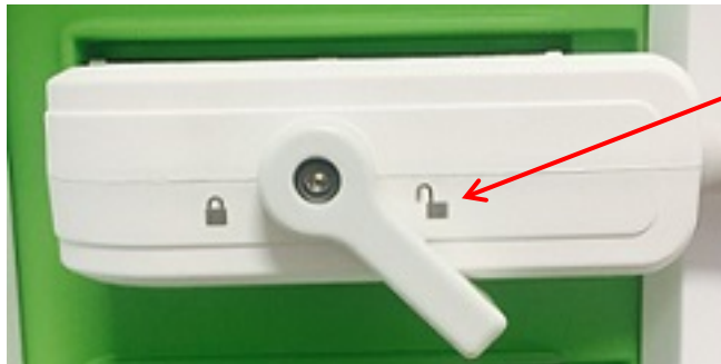
Kuva 29: Avattu anturin liittimen lukitussäädin avattuna
